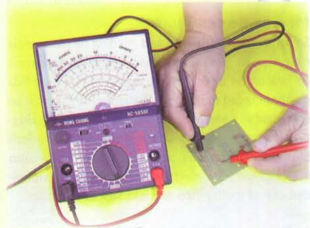
Figura 3.7. Medida de continuidad en una pista de un circuito impreso
